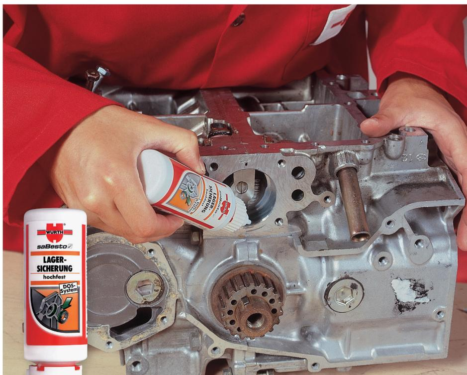
**Per il bloccaggio di elementi cilindrici, cuscinetti a sfera, bocche, ingranaggi, perni, alberi, ecc.**
